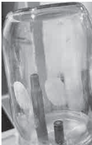
Рис. 4. Следы рук, выявленные при помощи самодельно изготовленной окуривающей камеры.
