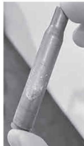
Рис. 4. Следы рук, выявленные при помощи самодельно изготовленной окуривающей камеры.
