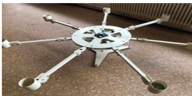
Рис. 1. Карусель для размещения банок с запахом с возможностью наклона банки в зависимости от роста собаки
