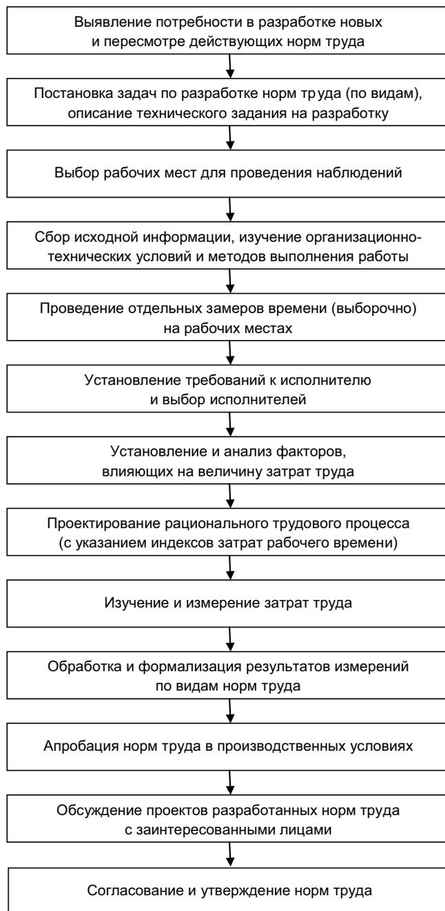
Рис. 2. Типовой алгоритм разработки норм труда
