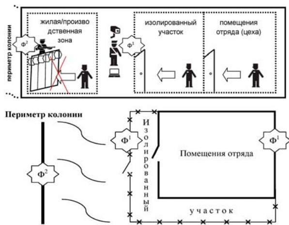
Рис. 2. Рубежи фортификации в ИК общего и строгого режимов (строительная инженерия + ИТСОН)
