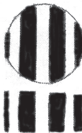
Рис. 3. Схематическое изображение шарика и следа, оставленного им на поверхности бумаги (окрашенные пастой участки выделены черным цветом)
