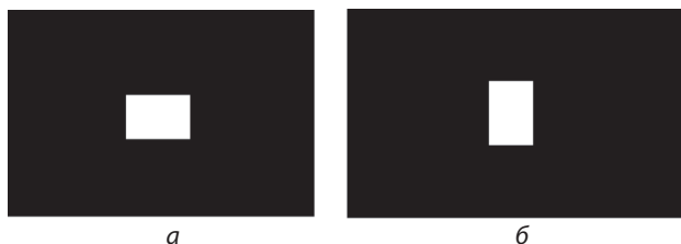
Рис. 7. Расположение отверстия в черном прямоугольнике (дополнительное приспособление для объектива): а) правильное расположение отверстия; б) неправильное расположение отверстия
