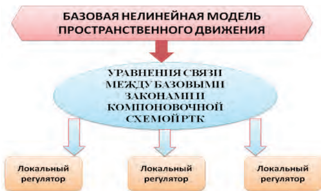
Рис. 7. Иерархия регуляторов для базовой нелинейной модели РТК
