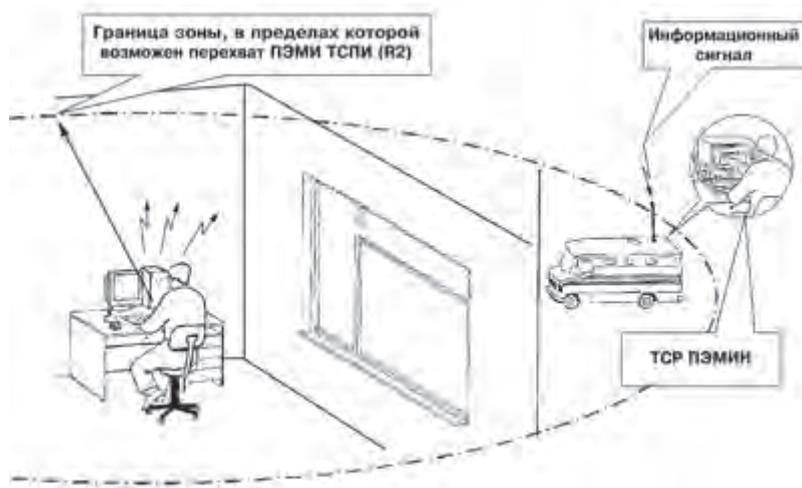
*Рис. 1. Перехват побочных электромагнитных излучений технического средства обработки и передачи информации (ТСПИ) средствами разведки ПЭМИН [2]*
