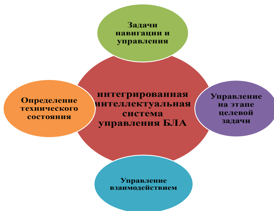
Рис. 10. Структура перспективной интегрированной интеллектуальной системы управления БЛА
