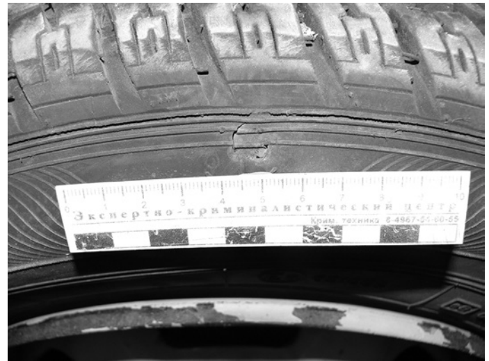
Рисунок 2. Сквозной пробой боковой поверхности шины (образован болтом или арматурой диаметром не более 10-11 мм)
