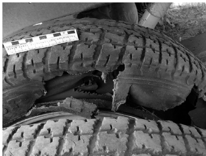
Рисунок 4. Обширные разрывы шины (образованы в ходе столкновения с автомобилем)
