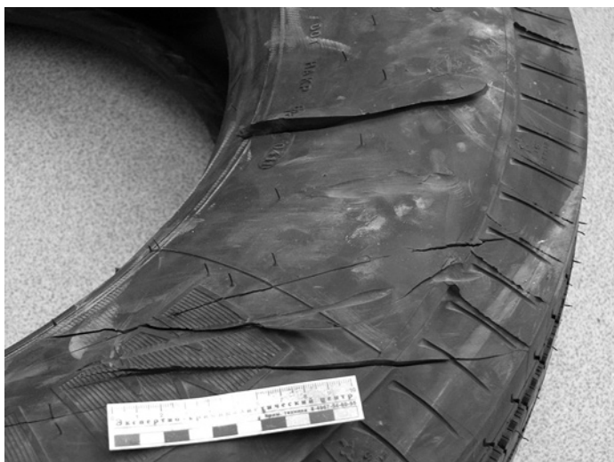
Рисунок 3. Поверхностные разрезы шины извилистой формы (образованы в ходе столкновения с автомобилем)
