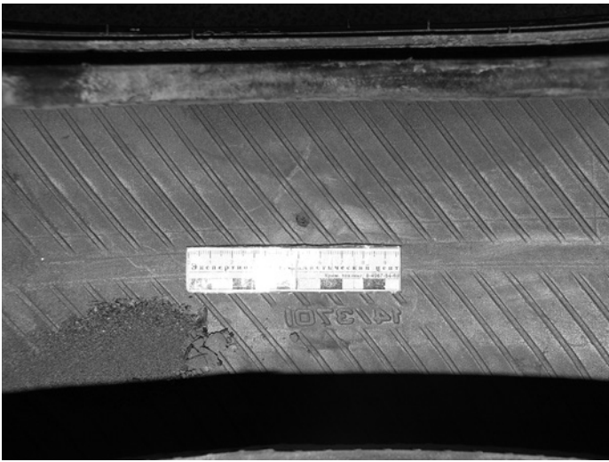
Рисунок 1. Сквозной прокол шины колеса (вид с внутренней стороны)
