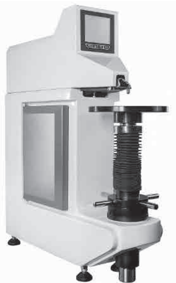
Рисунок 1. Твердомер Роквелла TP 5008A.
