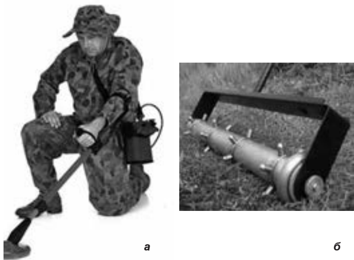
Рисунок 1. Поиск мелких предметов на открытой местности с использованием: а – металлоискателя; б – магнитного трала
