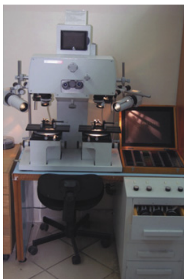
Микроскоп сравнения для криминалистических исследований МСК-1 предназначен для наблюдения и фотографирования в отраженном свете двух сравниваемых объектов, которые одновременно или раздельно видны в поле зрения
